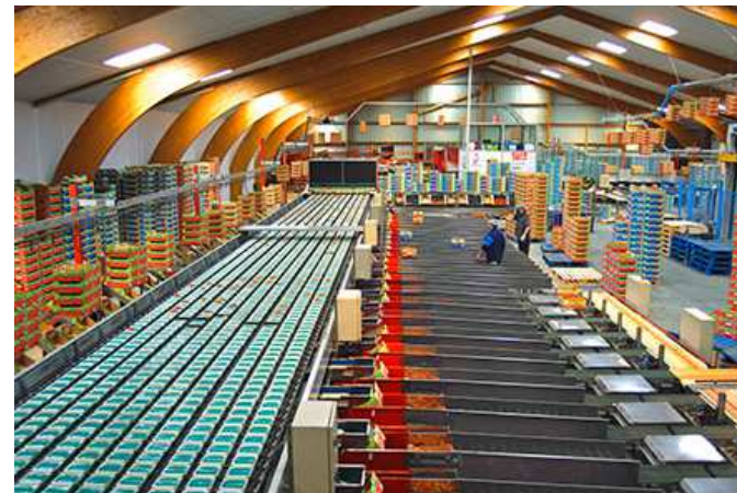
Chaîne de calibrage de tomates
