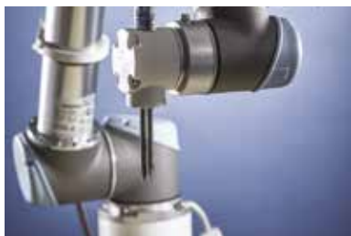
Robot équipé de sondes contenant un spectromètre proche infrarouge. © Carsten Seidel
